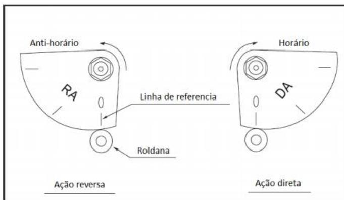
Ajuste do Zero: ajuste o sinal de entrada para 4 mA, corrente necessária para manter a válvula 100% fechada. Em seguida, movimente o "Ajuste do Zero" a fim de fechar o atuador e zerar a pressão indicada no manômetro. Observe que é necessário reduzir a pressão até zero e não fechar o ajuste por completo.
