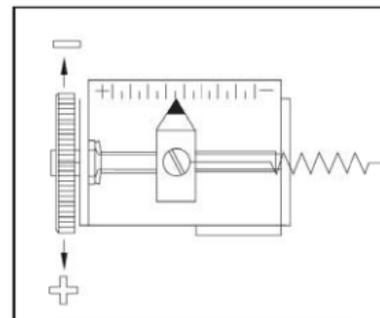
Ajuste do Span: alimente o posicionador com 20 mA, corrente necessária para manter a válvula em 100%. Ajuste o span de forma que o atuador chegue ao final de seu curso. Realizada esta etapa, volte ao zero (4 mA) e refaça o ajuste do zero. Obs: toda vez que for necessário reajustar o span, o instrumento deverá retornar à posição de zero e deverá ser refeito o ajuste do zero.
